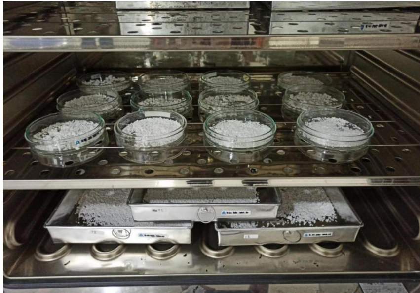
Gambar 1. Pengeringan Granul Paracetamol dengan Oven Memmert UN55
